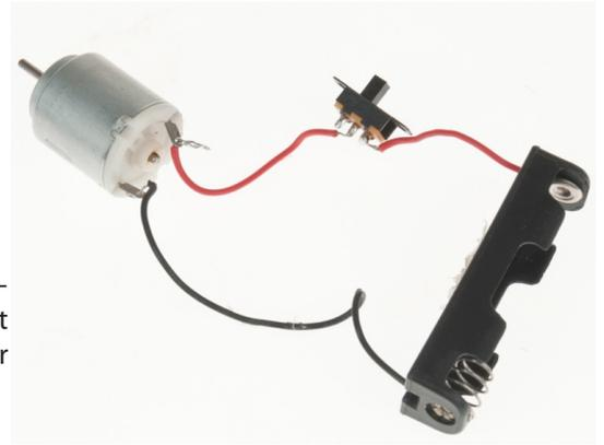
Contrôle de fonctionnement: Mettre une pile 1,5 V Mignon et actionner l'interrupteur. Le moteur tourne, si ce n'est pas le cas, contrôler les liaisons effectuées.
